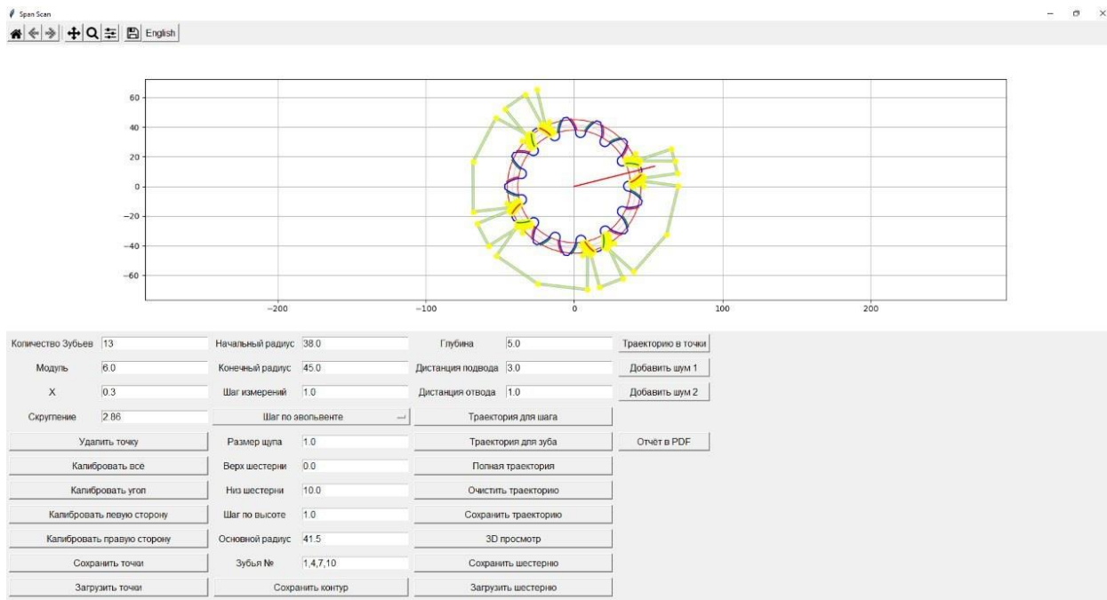
Рисунок 5.8. Траектория измерения выбранных зубьев.
